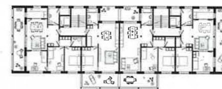
Regelgeschoss Lärmschutztyp, Frohes Wohnen
