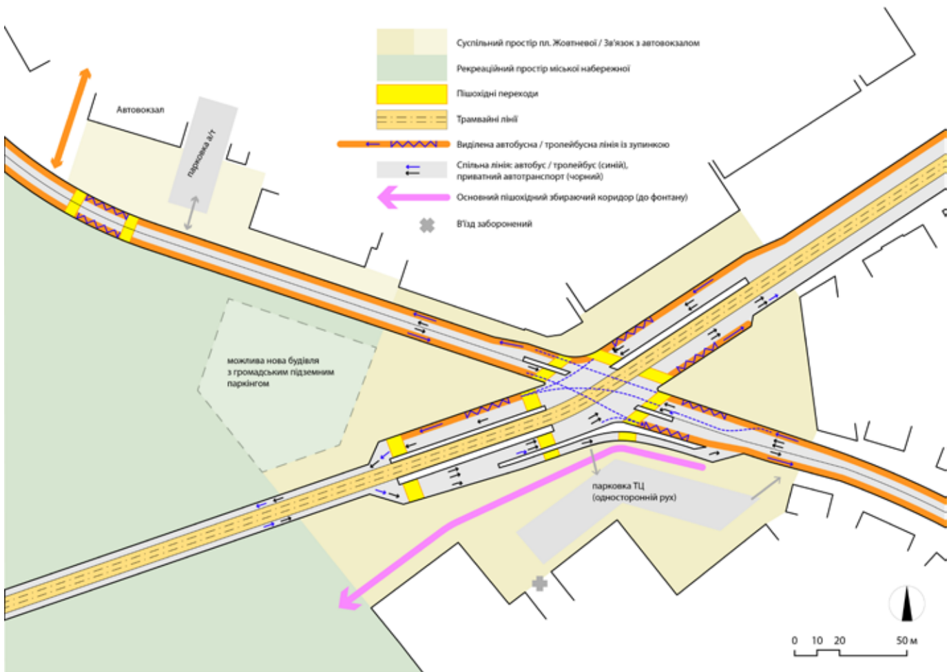
Схема: Жовтнева пл., варіант з організацією трамвайних зупинок відповідно до українських норм в кожному напрямку до перехрестя. Автобусні зупинки перенесені з вул.Соборної на пр-т Коцюбинського та вул.Островського.
